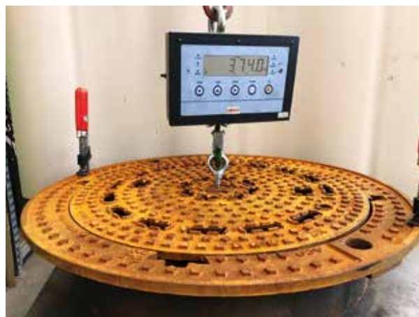
Auszugtest an einer fabrikneuen Schachtabdeckung
