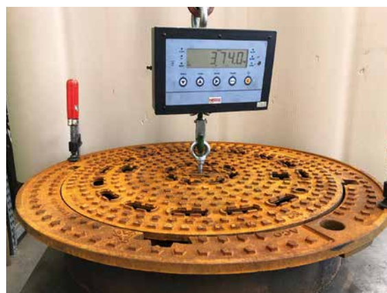
Auszugstest an einer fabrikneuen Schachtabdeckung
