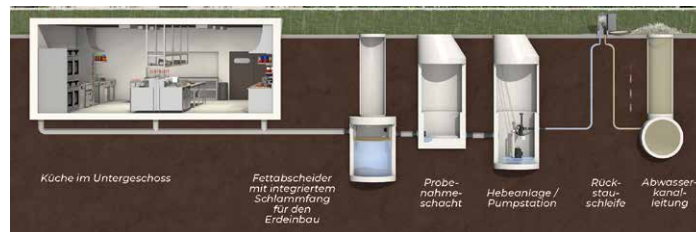
Beispiel für eine Fettabscheideranlage mit Rückstausicherung (Grafik: Mall)
