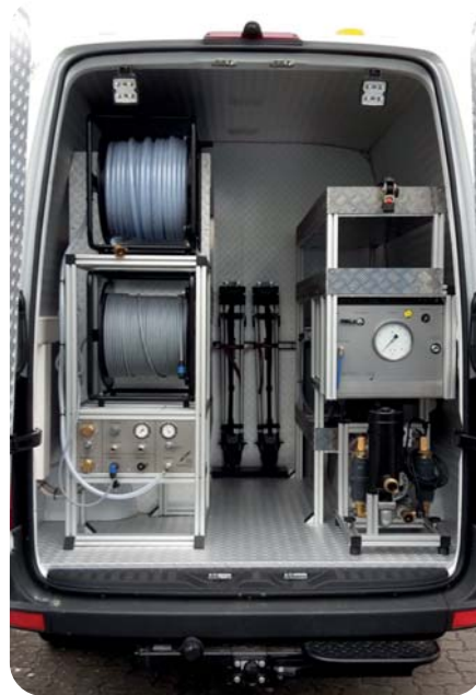
Blick in den Heckausbau eines Dichtheitsprüf- fahrzeugs
