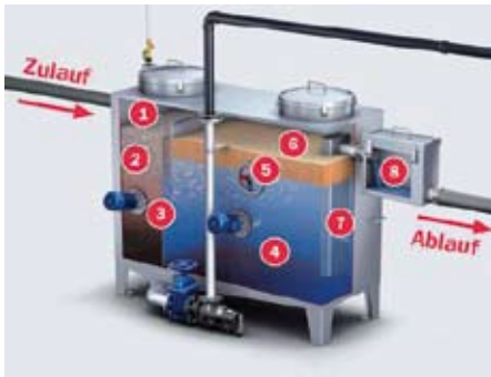
Prinzipskizze einer Fettabscheideranlage nach DIN 4040-100 (Bild: Basika)
