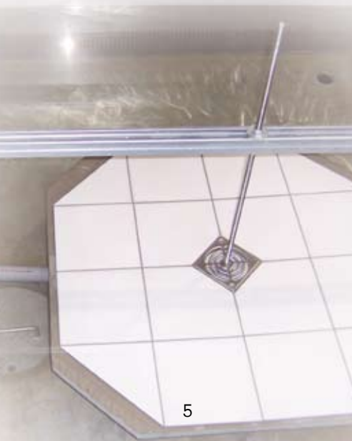
Maßkontrolle des Anschlussstutzens von Abläufen
