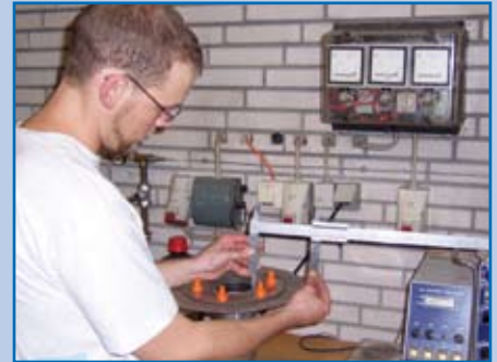
Maßkontrolle der Festflanschbreite von Abläufen
