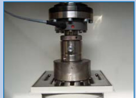
Belastungsprüfung für Klassifizierung von Ablaufrosten
