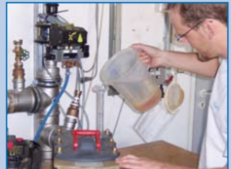
Simulation von Rückstau
