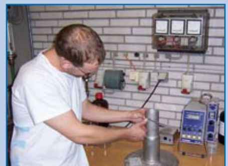
Maßkontrolle des Anschlussstutzens von Abläufen
